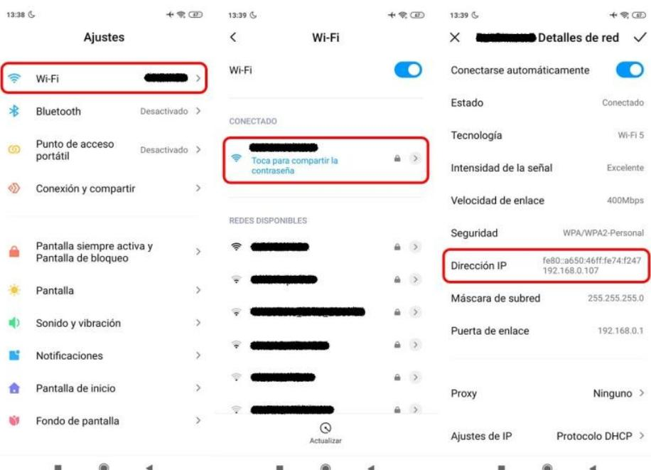
Si conectáramos otro dispositivo móvil la IP siguiente asignada seria 192.168.0.108 y así sucesivamente. Lo que vamos a hacer es asignar una IP estática, para que siempre podamos tener acceso al control de nuestra puerta mediante WiFi. Lo que haremos una vez localizada la IP de conexión, es solo cambiar los dos últimos números de la IP. En este caso hemos elegido el numero 110. Quedaría de la siguiente manera IP 192.168.0.110
